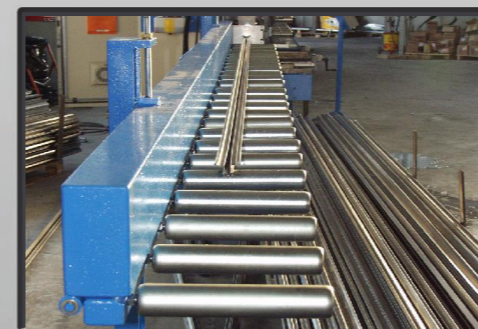
Banco di scarico
